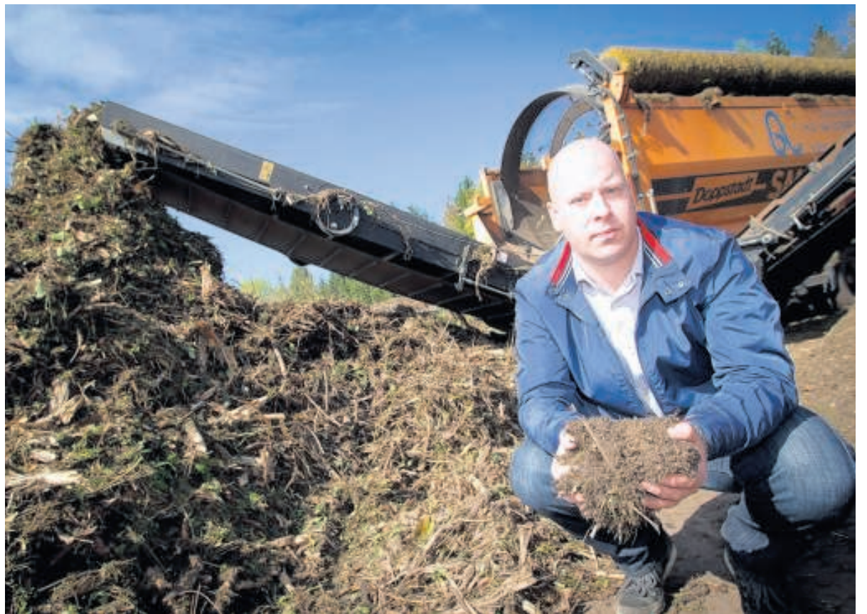
▲ Wilko van Dorresteyn bij een hoop biomassa die de shredder op de achtergrond uitbraakt. Dit afval gaat naar energiecentrales, het fijne afval wordt omgewerkt tot compost. FOTO JEROEN JUMELET
